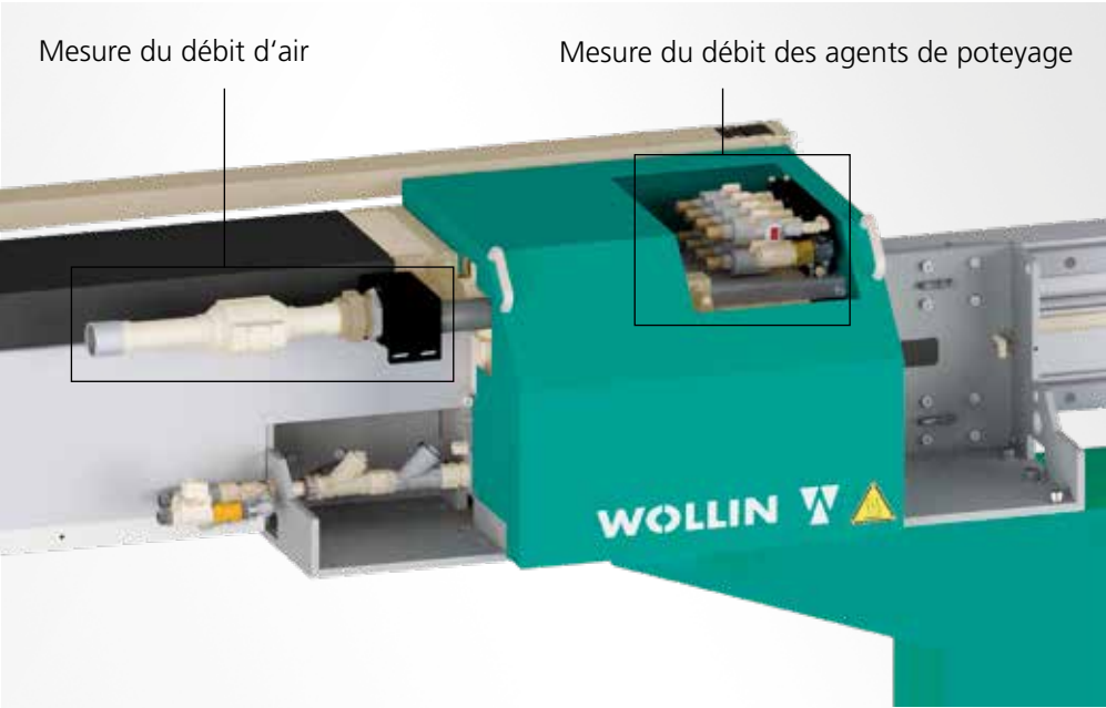
Unité horizontale ESM4 avec debimetres pour air et agent de poteyage.
