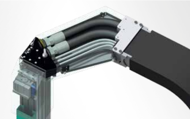
Nuevo concepto para el agente desmoldeante y la ruta del aire.
